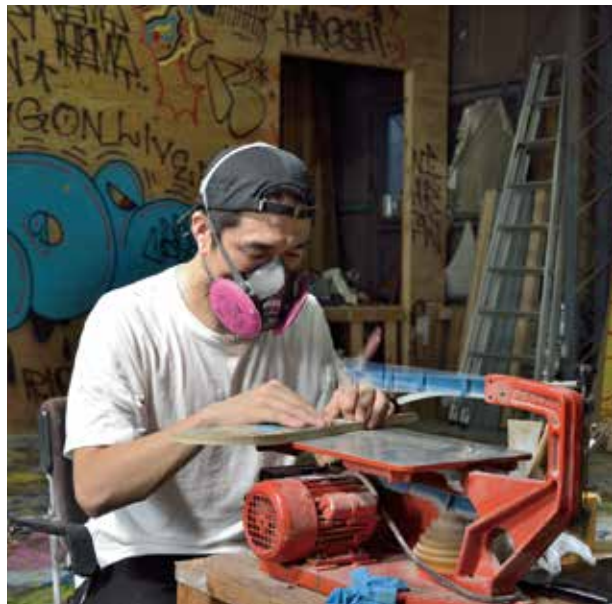
左／デッキのカット作業は全て糸のごぎりを用いて行われている。上／工房の隅に積み上げられたスケートボードの廃材。
